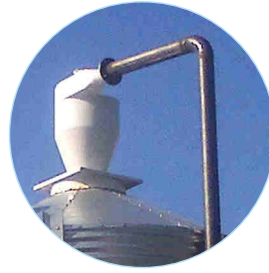
Opsiyonel olarak sunulan siglon sistemi
