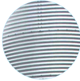
460 gr/m 2 galvanizli 1.2 mm yüksek kalite sac
